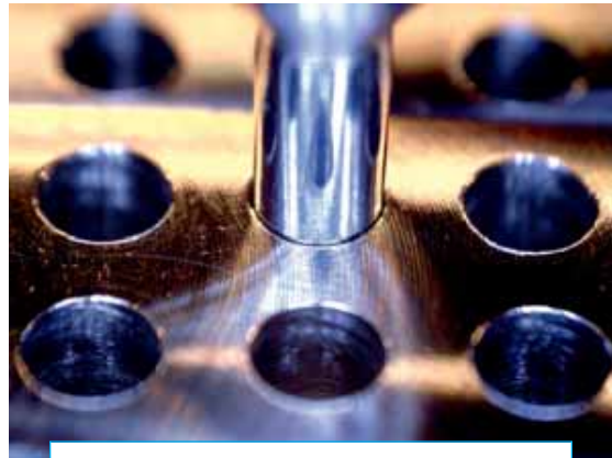
Les trous sont cylindriques, propres et avec des bavures minimales.
